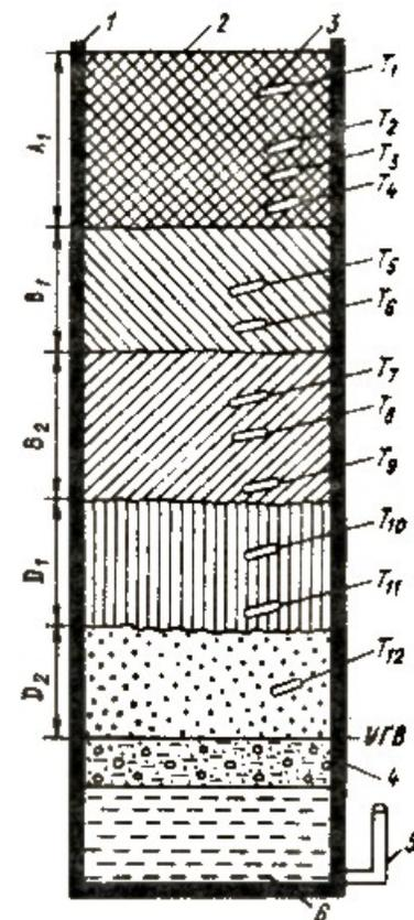
**Рис. 1.** Схема почвенной колонны. 1 – корпус, 2 – почва, 3 – датчик тензиометра, 4 – фильтр, 5 – пьезометр, 6 – грунтовые воды; T<sub>1</sub>–T<sub>12</sub>–тензиометры.
